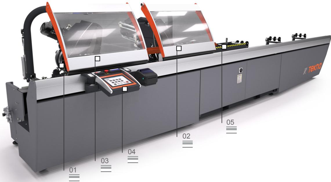
Tronzadora de doble cabezal de 3 ejes controlados con movimiento automático del cabezal móvil y gestión electrónica de todos los ángulos de 45° (internos) a 15° (externos) con una precisión, dentro de cada grado, de 280 posiciones.
