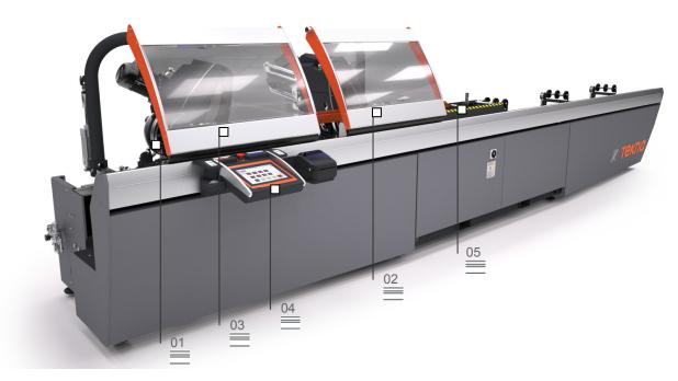
Troncatrice doppiatesta a 3 assi controllati con movimento automatico della testa mobile e gestione elettronica di tutte le angolazioni da 45° (interni) a 15° (esterni) con una precisione, all'interno di ogni grado, di 280 posizioni.
