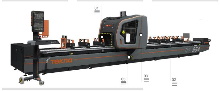
Centre d'usinage à 4 axes à CN doté d'un portique mobile et conçu pour le perçage, le fraisage et le filetage, à n'importe quel angle de  $-90^{\circ}$  à  $+90^{\circ}$ , de barres ou de pièces en aluminium, PVC, alliages légers et acier jusqu'à 2 mm d'épaisseur. La section mobile de la machine est constituée d'un portique pourvu d'une motorisation double type gantry à crémaillère de
