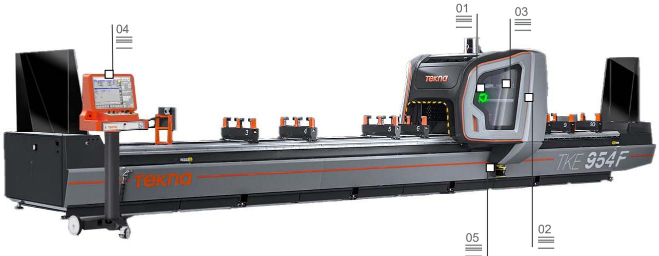
Centre d'usinage CN à 4 axes doté d'un portique mobile et conçu pour le perçage, fraisage et taraudage, avec n'importe quel angle de  $-90^{\circ}$  à  $+90^{\circ}$  de barres ou de pièces en aluminium, PVC, alliages légers et acier jusqu'à 2 mm d'épaisseur. La section mobile de la machine est constituée d'un portique pourvu d'une motorisation double type gantry à crémaillère de précision.
